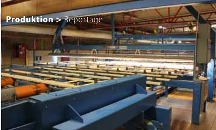
Ein Boardmaster von Finscan wird bei Setra für getrocknete Ware eingesetzt
