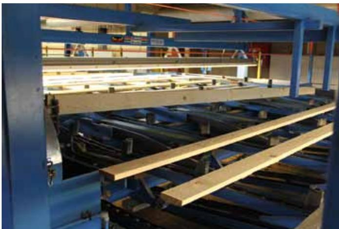
Die Wendevorrichtung dreht die Bretter nach dem ersten Boardmaster, bevor der zweite Scanner die restlichen drei Seiten untersucht
